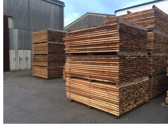
製材後風通しの良い場所で2～3ヶ月天然乾燥させます。
